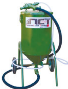
Рис.5 Струйно-абразивная обработка поверхности ортотропной плиты: а) пескоструйный аппарат б) процесс очистки металла
